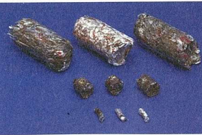
RPFは、Refuse derived paper and plastics densified Fuelの略称。古紙と廃プラスチック類を主原料とした高品位の固形燃料だ
