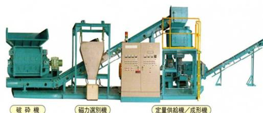
破砕機 磁力選別機 定量供給機/成形機
